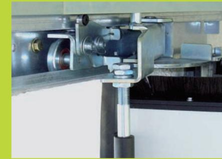
**Dettaglio del carrello con deragliatore superiore per rotazione pacco 180° (Pat. Pend.).**
