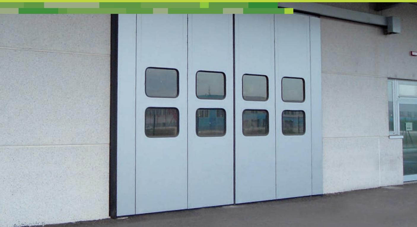
Porta industriale scorrevole senza guida a pavimento. Le ante, realizzate tramite processo di schiumatura poliuretanic, sono sospese alla guida superiore. Le porte scorrevoli SC rappresentano una valida soluzione anche per aperture di grandi dimensioni e possono essere dotate di ogni tipo di accessorio. La manovra può essere manuale o motorizzata. Possono essere installati sia all'interno che all'esterno del fabbricato. **A richiesta può essere dotata di "anta tagliata" senza zoccolo a terra.**
