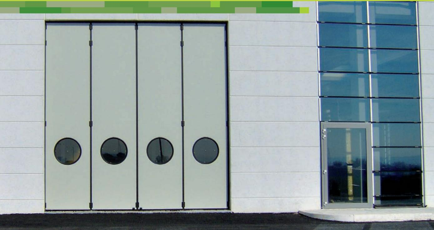
Porta industriale con apertura a libro senza guida a pavimento. Le ante, realizzate tramite processo di schiumatura poliuretana, sono incernierate ai montanti laterali e offrono facilità di manovra nell'apertura e nella chiusura. Prodotta su misura, rappresenta la giusta soluzione per ogni esigenza di medie dimensioni. **Le cerniere sono fissate alle ante con sistema antieffrazione.**
